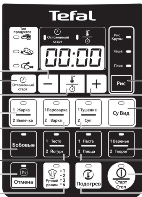
1. 17 основных функций: «Отложенный запуск», «-», «Температура/Таймер», «Жарка/Выпечка», «Пароварка/Варка», «Бобовые», «Тесто», «Йогурт», «Подогрев/Отмена», «Ручной режим», «Старт/Стоп», «Разогрев», «Варенье/Творог», «Тушение/Суп», «Рис/Крупы», «Каша», «Плов», «+/-». При нажатии на клавишу раздается звуковой сигнал.
