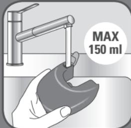
**CS** Naplňte nádržku na vodu maximálně 150 ml neupravené vody z vodovodu.
