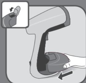
**BS** Vratite spremnik za vodu na mjesto na aparatu. Provjerite je li spremnik za vodu ispravno postavljen i blokiran.
