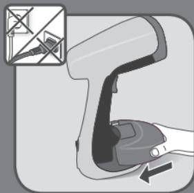
**EL** Τοποθετήστε ξανά τη δεξαμενή νερού στη θέση της και ασφαλίστε τη στη συσκευή. Βεβαιωθείτε ότι η δεξαμενή νερού είναι πλήρως τοποθετημένη στη θέση της.
