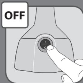
**FI** Kytke laite pois päältä painamalla virtapainiketta.
